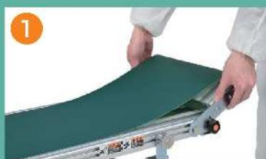
1 ベルトゆるめ装置でベルトをゆるめる
